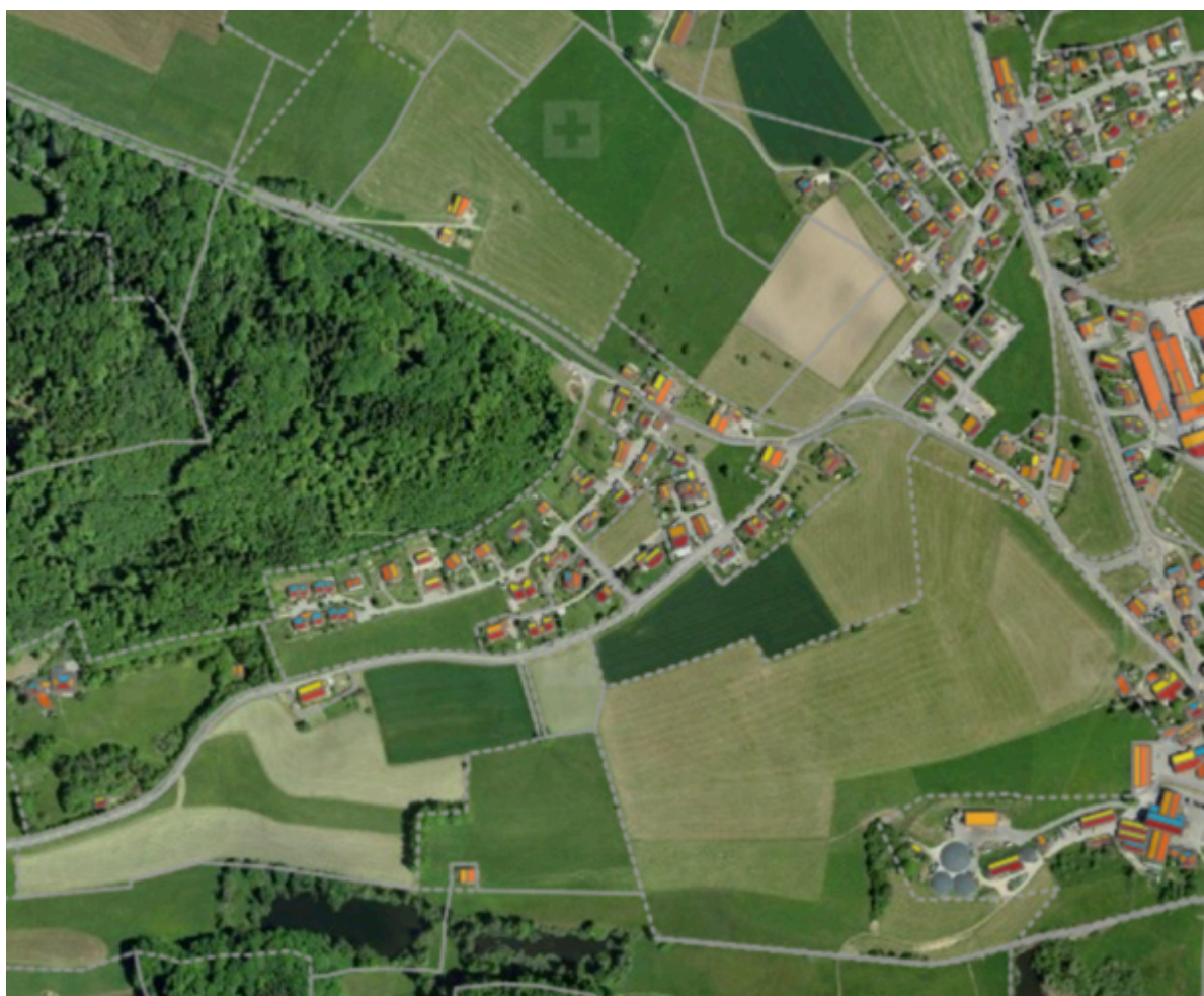
Figure 4 : extrait de www.toitsolaire.ch L'aptitude des toitures est estimée pour chaque bâtiment. Plus c'est rouge foncé, plus le rendement potentiel est élevé.
